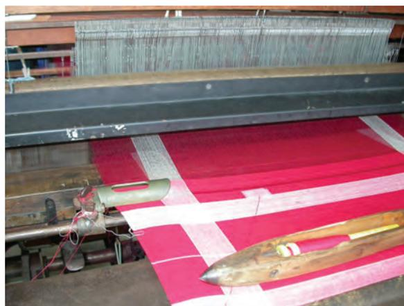
**Fig. 91** Pormenor de um tear com os fios da teia montados, a trama, a naveta ou lançadeira e outros instrumentos.
