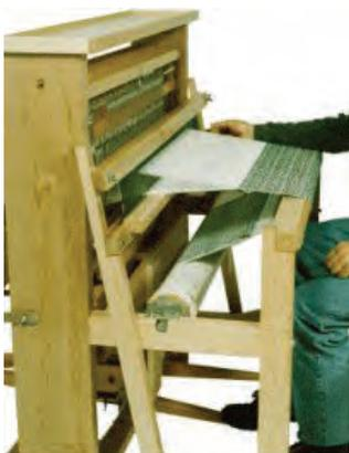
**Fig. 123** Tear de baixo liço com a teia montada e o tempereiro.
