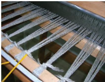
**Fig. 94** Vista de pormenor da montagem de uma teia.
