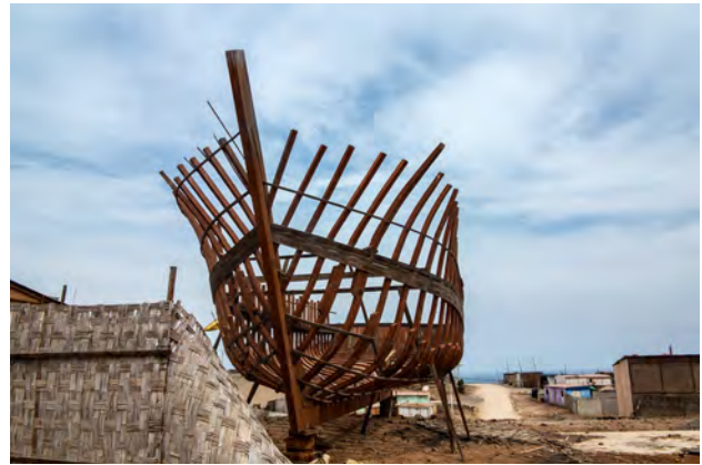
Figura 11 Estrutura do casco de um barco.
